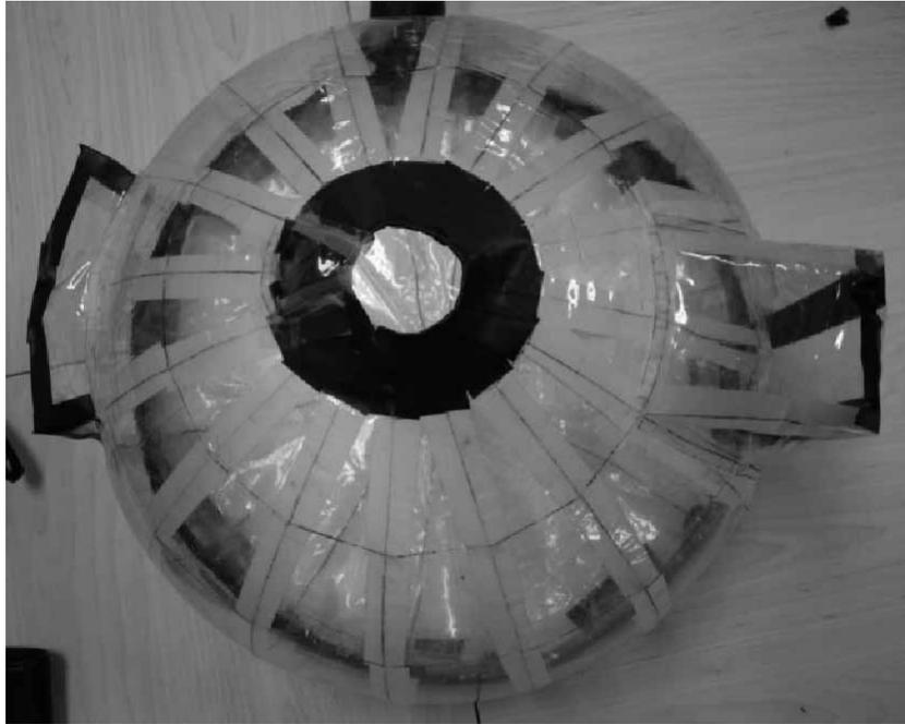
**Imagen 13. Unión de cada gajo de película de vinilo con cinta adhesiva de presión de PVC y círculo en el punto más alto de la estructura.**
