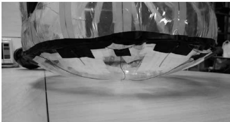
**Imagen 14. Deformación de la base de la estructura debido a la presión interna de aire.**
